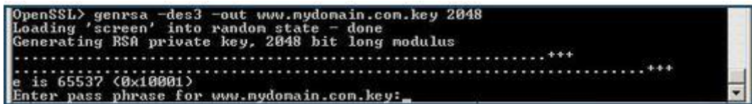
ภาพที่ 3 การใช้ command line ในการสร้างทั้งกุญแจคู่รหัสไฟล์ CSR
